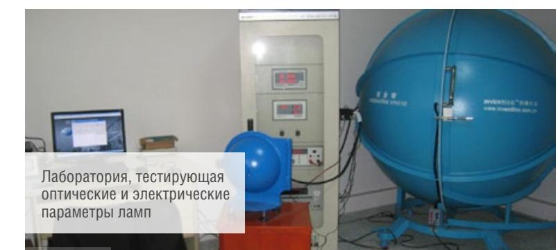
Лаборатория, тестирующая оптические и электрические параметры ламп
