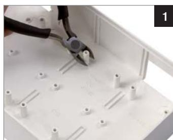
Удалить выступающие элементы крепления розеточного модуля
